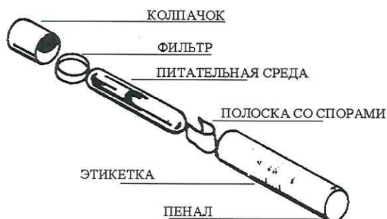
Рис. 1. Биологический индикатор марки «DGM Steriguard»
